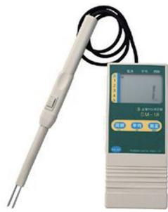
Alat pengukur kadar air di dalam tanah
