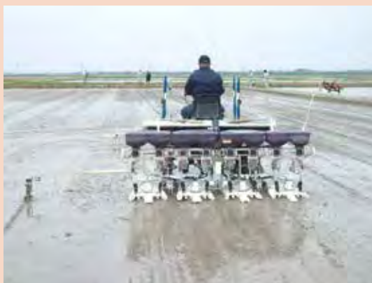
直まき栽培（播種機を装着した多目的田植機）
