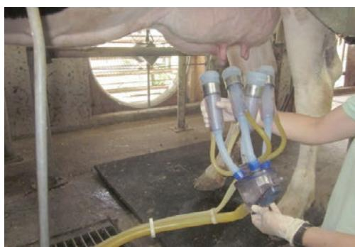
真空を遮断し、少し待ってから自然落下に合わせて4本同時に離脱する
