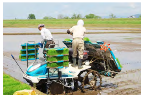
Minib boshqariladigan guruch transplantatori yordamida, ko'chirib ekish
