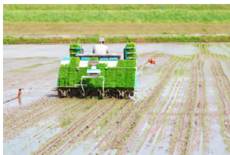
Minib boshqariladigan guruch transplantatori yordamida, ko'chirib ekish
