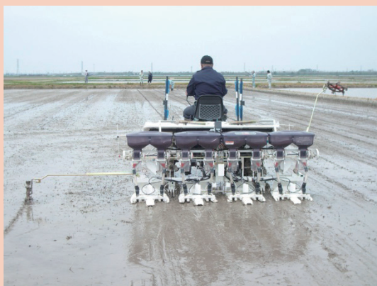
การปลูกแบบหว่านตรง (เครื่องปักต้นกล้าอเนกประสงค์ที่ติดตั้งเครื่องหว่านเมล็ด)
