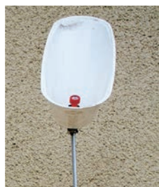
หัวฉีดที่ใช้กันทั่วไปในการฉีดพ่นน้ำยากำจัดวัชพืช
