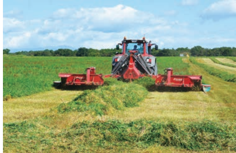
การตัดหญ้าด้วยเครื่องตัดหญ้าและปรับสภาพหน้าดิน (Mower Conditioner)
