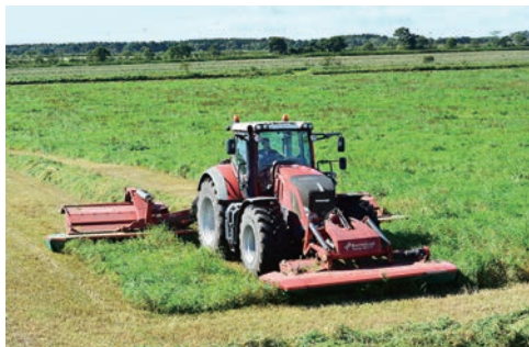
การตัดหญ้าด้วยเครื่องตัดหญ้าและปรับสภาพหน้าดิน (Mower Conditioner)
