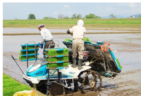
Minib boshqariladigan guruch transplantatori yordamida, ko'chirib ekish
