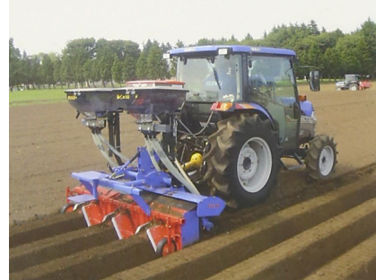
Baland tizmalarni hosil qiluvchi texnika
