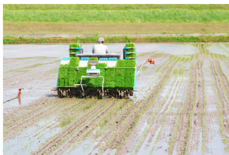
Minib boshqariladigan guruch transplantatori yordamida, ko'chirib ekish
