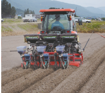
Pastqam tizmalarni hosil qiluvchi texnika
