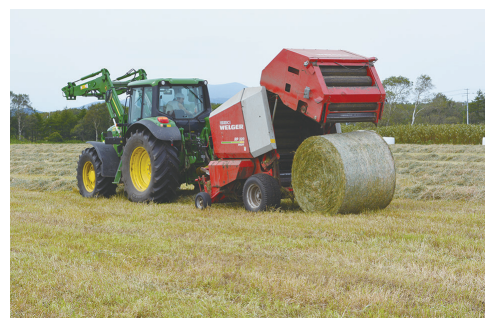
Rolikli presslash mashinasi bilan qadoqlash ishlari
